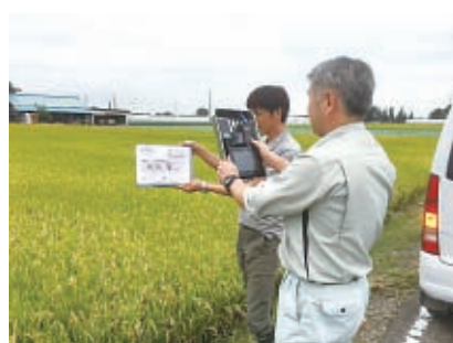
図1 近赤外線カメラによる生育状況の測定
