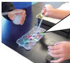
【6学年「水溶液の性質」】 ムラサキキャベツ指示薬で身の周りの水溶液の液性を調べた。家庭でも実験できるように試験管の代わりに卵パックを用いている。授業後、実際に家庭で実践した児童もいて、興味・関心が持続するとともに、以下で述べる日常生活との結び付きの実感にもつながった。
