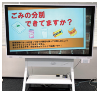
▲ RICOH Interactive Whiteboard 打合せの時には電子黒板として利用し、それ以外のときにはデジタルサイネージとして利用
